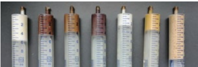
Różnica objętości próbek o masie 3 g. Od lewej: SV 36, HV 36, SV 427, HV 427, biel, ugiel, pył drzewny (aut. O. Kowalska).
